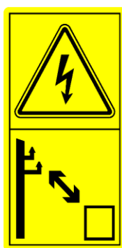
Рис.10 – аппликация БП 1000.800.805 «Сохраняйте дистанцию от линий электропередач»
